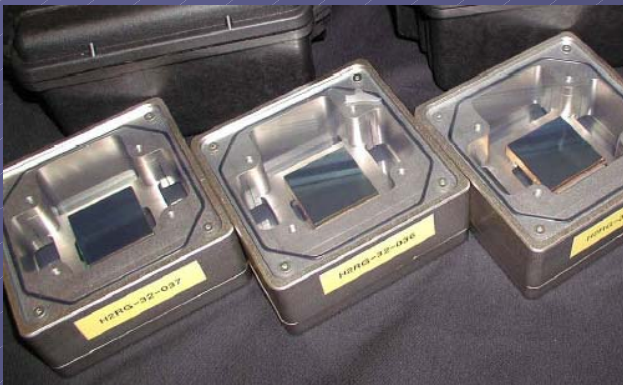
2k x 2k, 1.7\mu\text{m} HgCdTe
